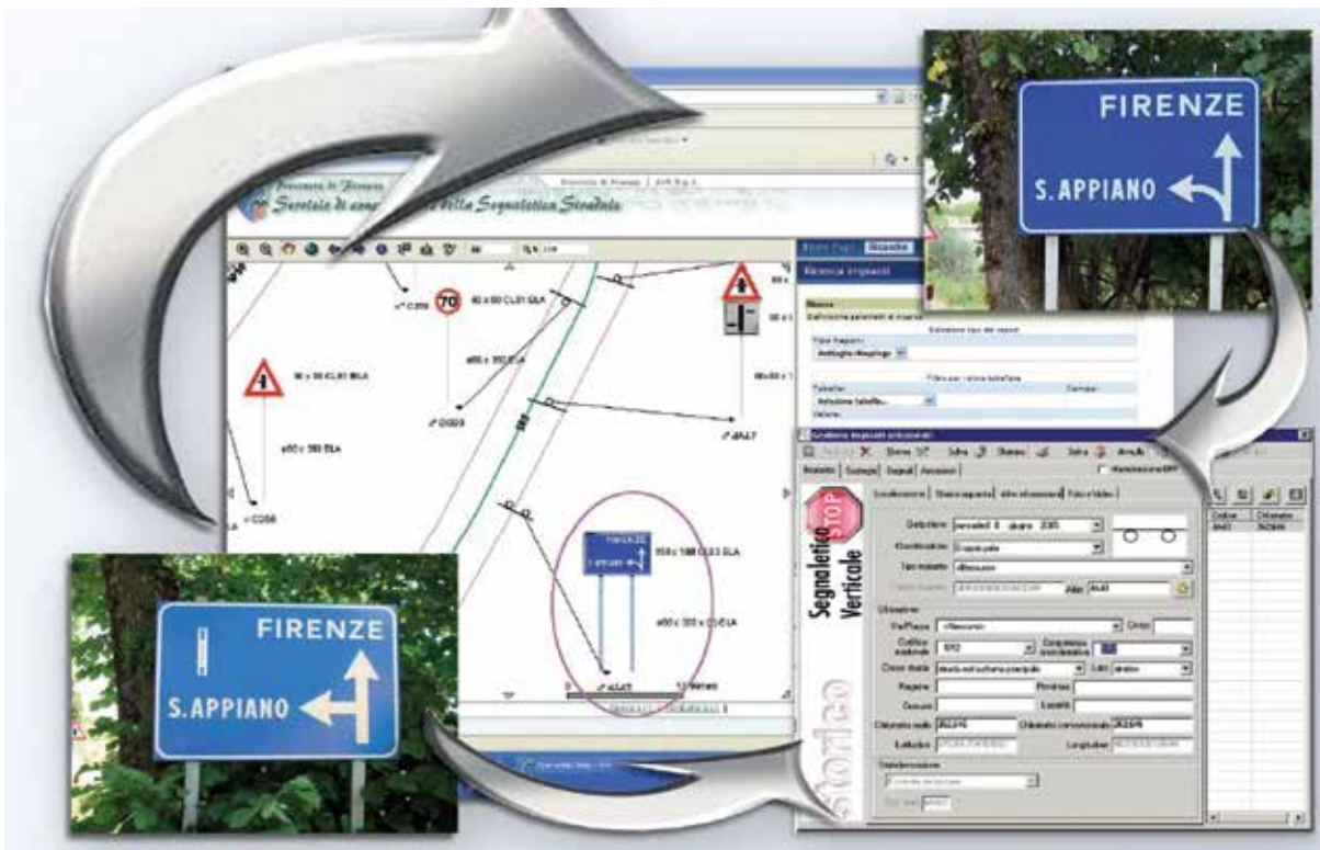
Sistema di gestione con database cartografico GIS, condivisibile in rete ed in simultanea con tutti i tecnici interessati
