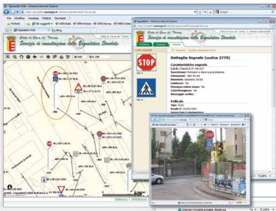
Esempio di database cartografico GIS per la gestione del catasto della segnaletica stradale con inserimento anche di foto del contesto ambientale
